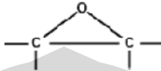
Gambar 2.15 Struktur Dasar Resin Epoksi [30]
