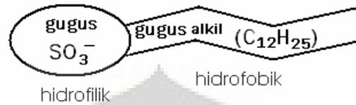
Gambar 2. 6 Skema Surfaktan SLS
