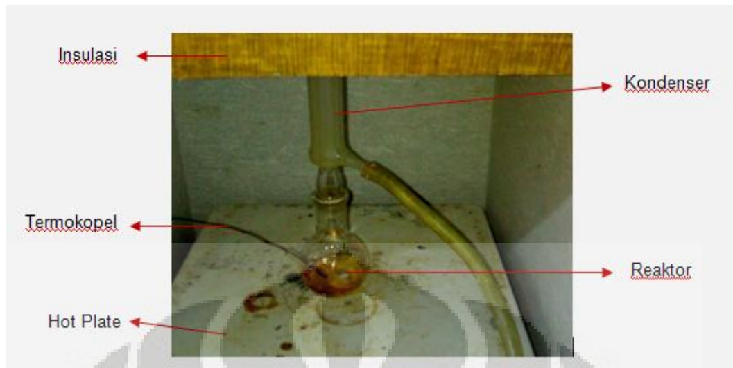
Gambar 3. 4. Rangkaian alat pada saat reaksi perengkahan
