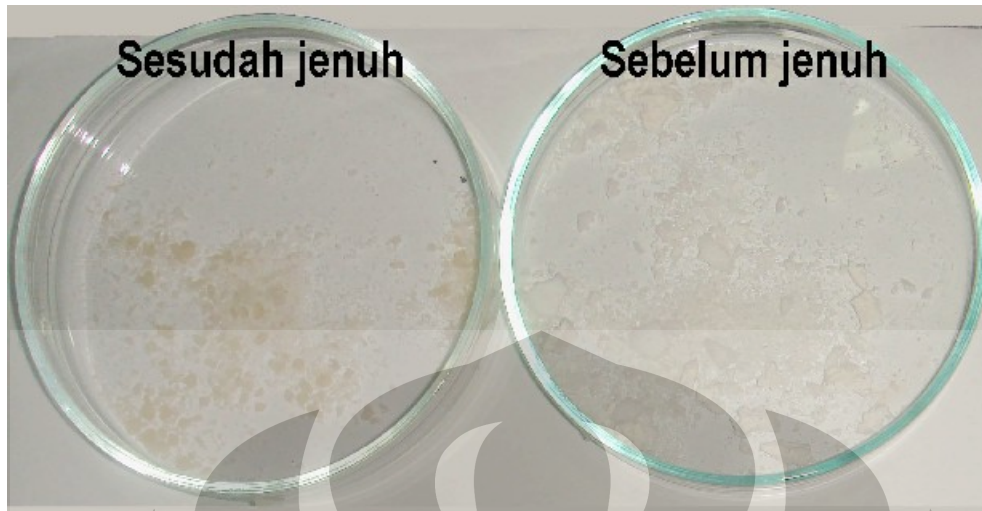
Gambar 4.3 Perubahan warna silika gel
