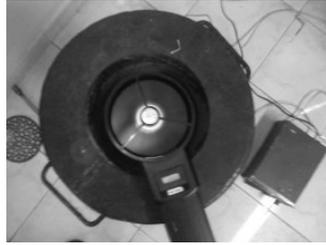
Gambar 3.9 Cara Kalibrasi Kecepatan *Forced draft*
