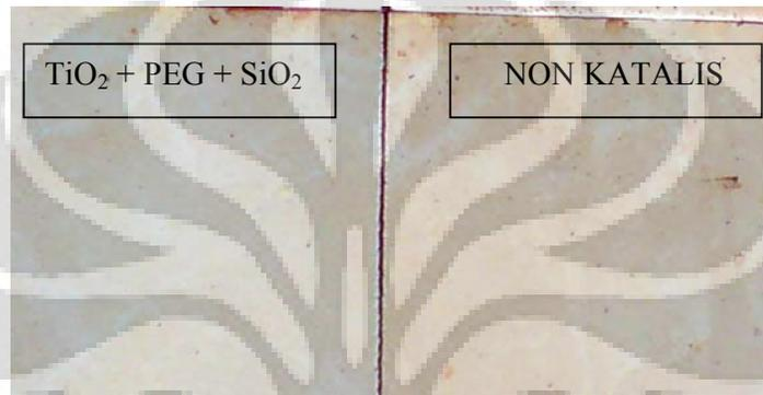
**Gambar 4. 11** Uji self-cleaning pada keramik di dalam dapur selama 2 bulan
