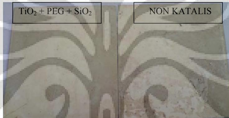
**Gambar 4. 10** Uji self-cleaning pada keramik di dalam kamar mandi selama 2 bulan
