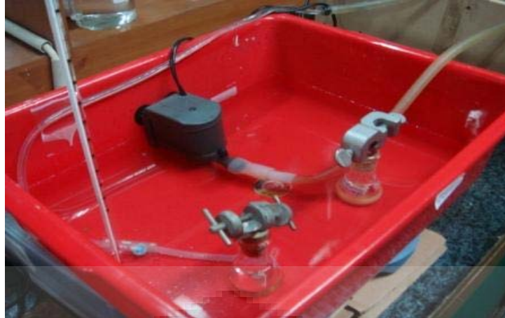
Gambar 4. 31 Tahap reaksi sintesis biodiesel melalui rute non alkohol untuk uji variasi temperatur pada T = 25^{\circ}\text{C}
