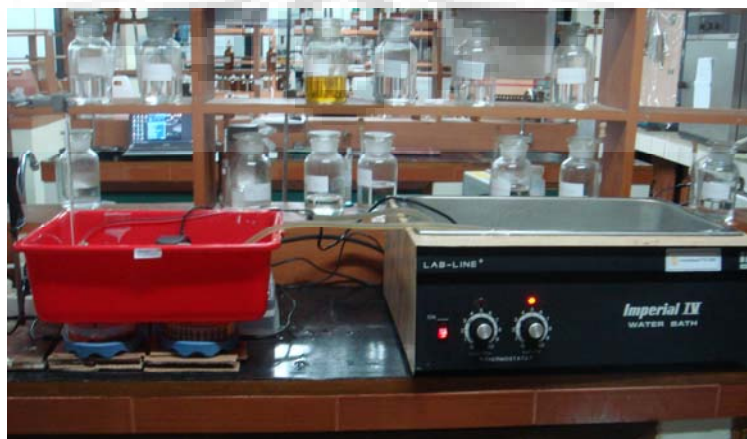
Gambar 4. 30 Tahap reaksi sintesis biodiesel melalui rute non alkohol untuk uji variasi temperatur pada T = 50^{\circ}\text{C}
