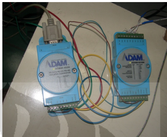
Gambar 4.10 Adam 4018 hardware yang telah diset-up ke PC
