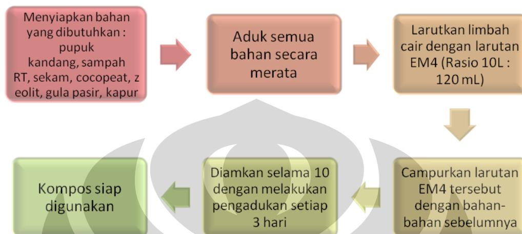
Gambar 3. 3 Diagram Prosedur Pengomposan
