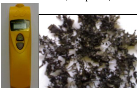
Gambar 4. CO Detector ( kiri ) dan Lelehan Plastik Kresek Setelah Gasifikasi ( kanan )
