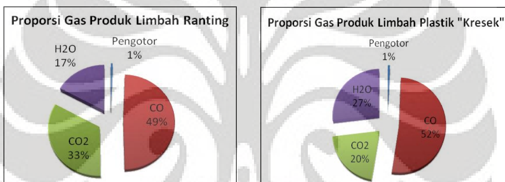
Gambar 4.13 Pie Chart Komposisi Gas Produk Gasifikasi Plamas Non-Termal Limbah Ranting (kiri) dan Limbah Plastik "Kresek" (kanan)
