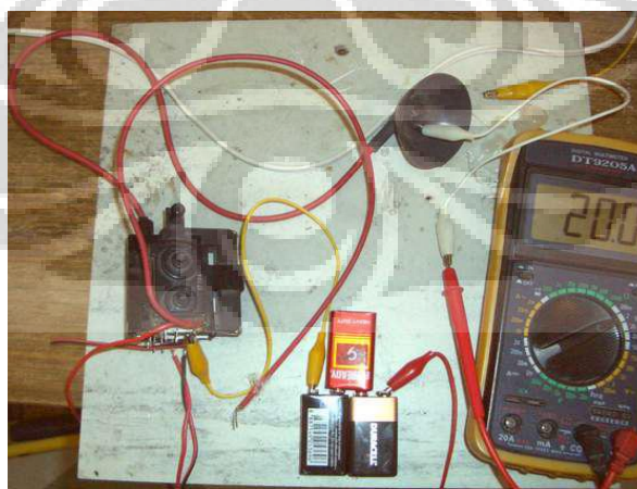
Gambar 3.5 Skema Untuk Menemukan Kaki Sekunder Flyback
