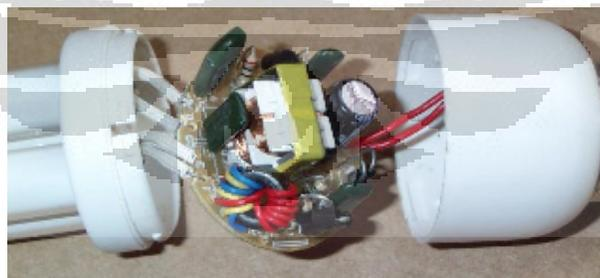
**Gambar 3. 2. Contoh *ballast* CFL 220 V yang digunakan**
