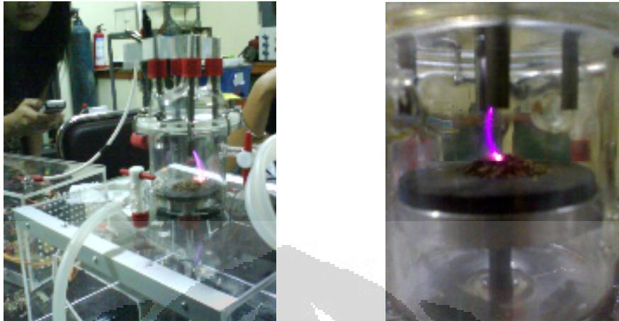
**Gambar 4. 1.** Proses gasifikasi yang dilakukan dengan menggunakan 5 buah elektroda
