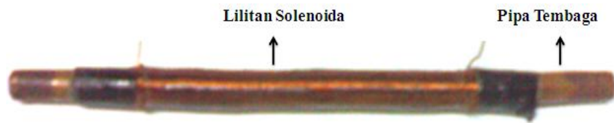
Gambar 3. 2 Pipa Tembaga dengan 120 Lilitan Solenoida
