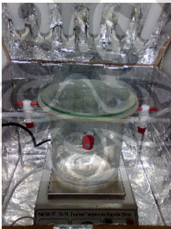
**Gambar C. 2** Reaktor quartz untuk pengujian produksi hidrogen
