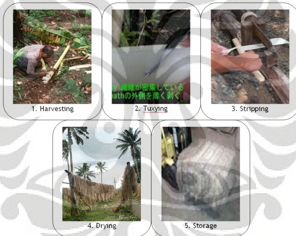
Gambar 2.5 Proses Pembuatan Serat Pisang Abacca
