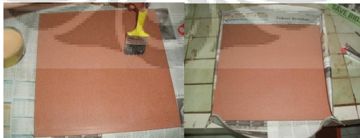
Gambar 3.17. (a) Keramik dioleskan Mirror Glaze hingga rata
