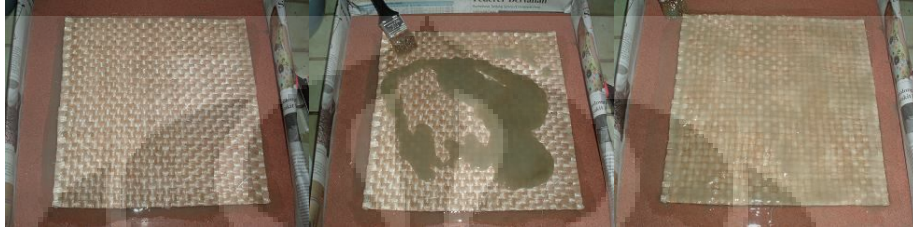
Gambar 3.20. (a) Abaca diletakkan diatas resin yang telah diratakan (b) Menuangkan resin diatas anyaman abaca (c) Resin yang dituang kembali diratakan
