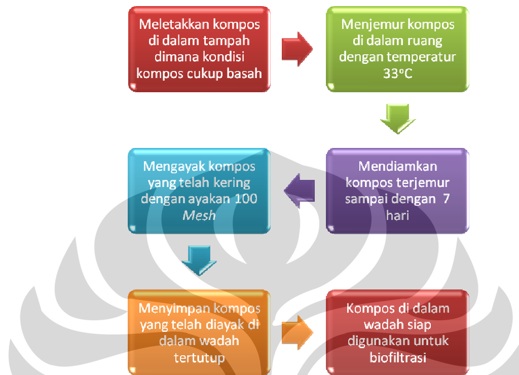
Gambar 3.5 Skema prosedur preparasi kompos yang sudah jadi sebelum biofiltrasi dilakukan
