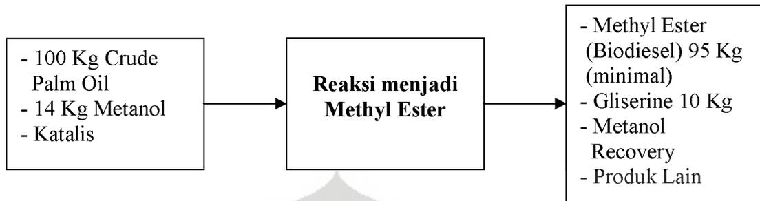
Gambar 2.7 Diagram Blok Pembuaan Biodiesel dari CPO [8]
