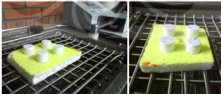
Gambar 4.1 Penempatan tabung reaksi tertutup dalam *shaking waterbath*
