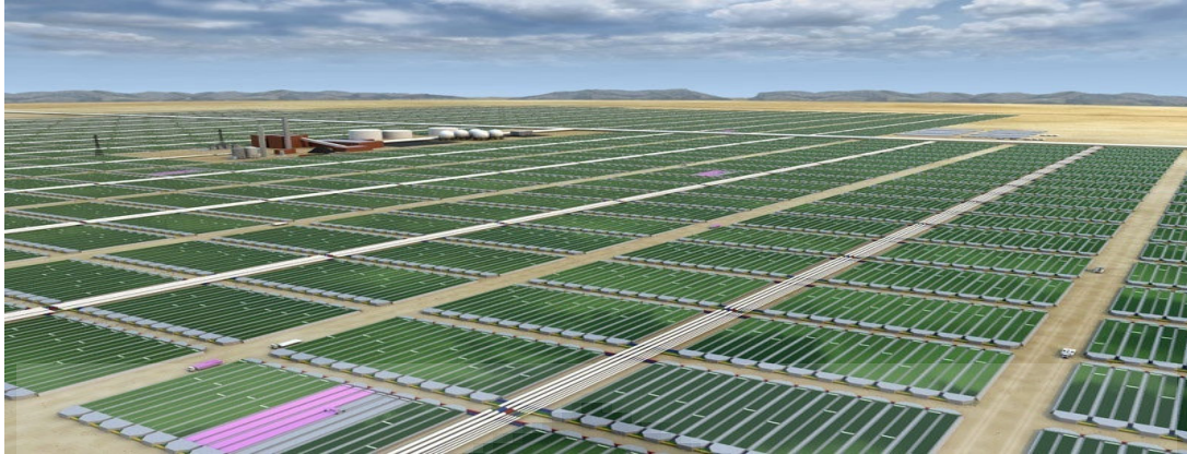
Gambar 2.7. Fotobioreaktor Terbuka untuk Pemiakan Chlorella vulgaris www.energypowershift.com/developments.htm
