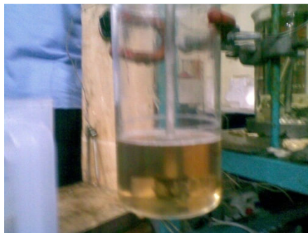
Gambar 4.2 Sabun yang dihasilkan dari reaksi hidrolisis minyak jarak dalam larutan NaOH 3,24 M
