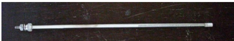
Gambar 3.9. Elektroda tegangan tinggi SS-316
