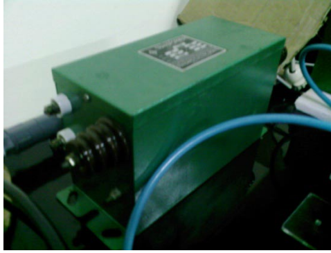
Gambar 3.5. Foto Neon Sign Transformer yang digunakan
