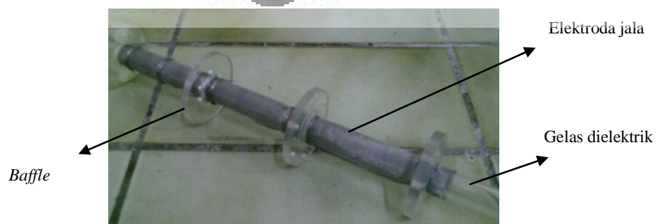
Gambar 3.11. Pemasangan Elektroda Jala
