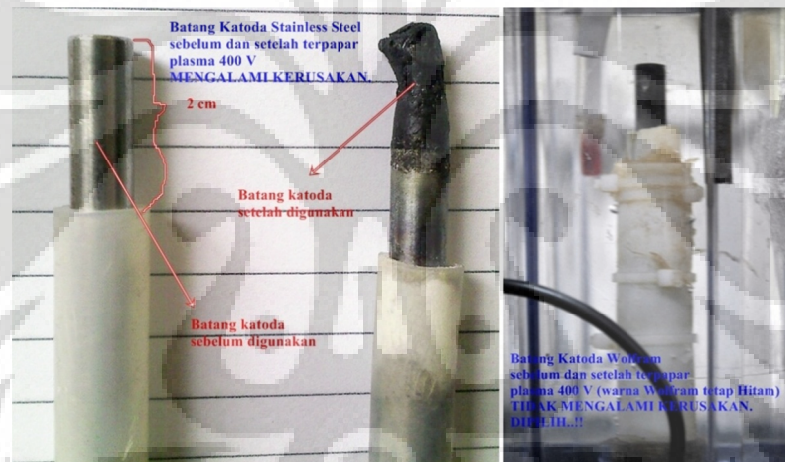
Gambar 4.3 Perbandingan Katoda Stainless Steel dengan Katoda Wolfram Karena Paparan Plasma
