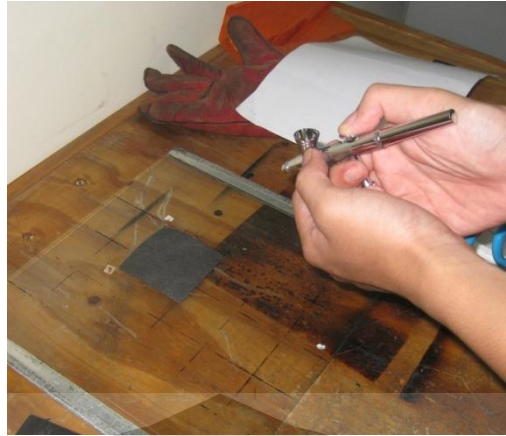
Gambar 3.5 Proses deposisi lapisan katalis menggunakan air brushing
