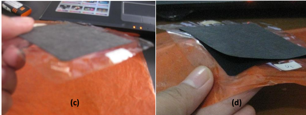
Gambar 4. 7 (a) Katoda MEA non MPL yang tampak tidak merekat pada PEM (b) MEA MPL 10% ada sebagian daerah yang tidak merekat.(c) MEA MPL 20% masih merekat dengan baik, dan (d) MEA MPL 30% ada sebagian daerah yang tidak merekat.
