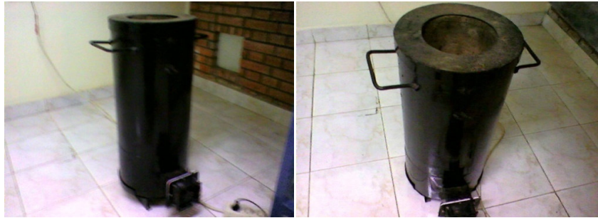
Gambar 3. 5 Kompor briket batubara DTK UI dengan blower
