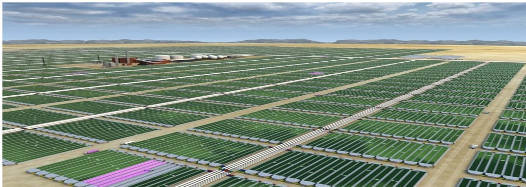
Gambar 2.5. Fotobioreaktor Terbuka untuk Pemiakan Chlorella vulgaris
