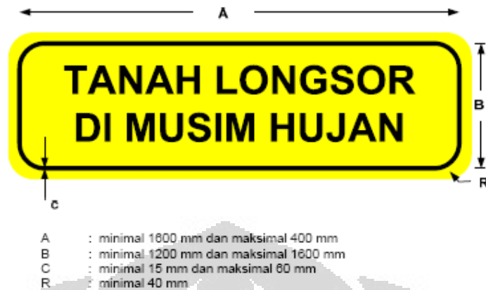
Gambar 2. 8 Spesifikasi Ukuran Papan Berbentuk Persegi Panjang
