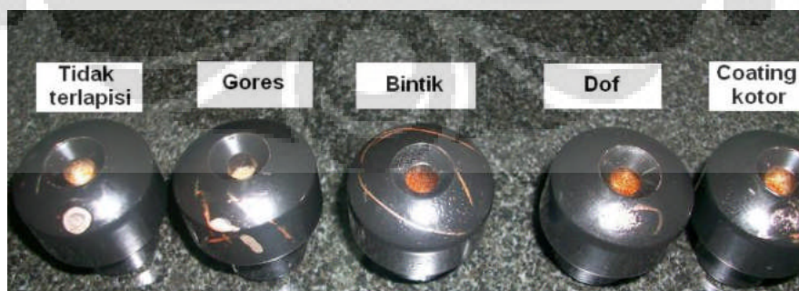
Gambar 1.1 Jenis-jenis defect visual pada komponen Weight A Steering Handle
