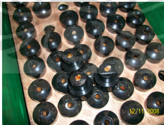
Gambar 4.3 kondisi penempatan komponen yang salah
