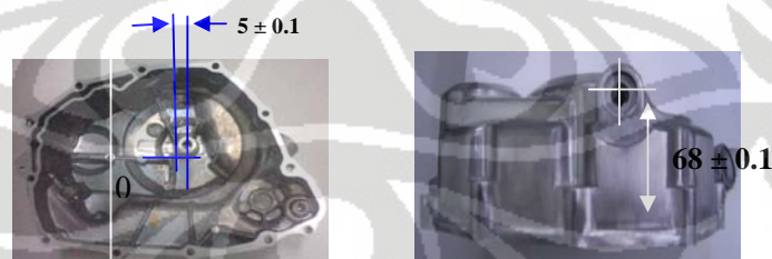
Gambar 4.5. Ilustrasi bagian part yang berpengaruh pada sistem kopling
