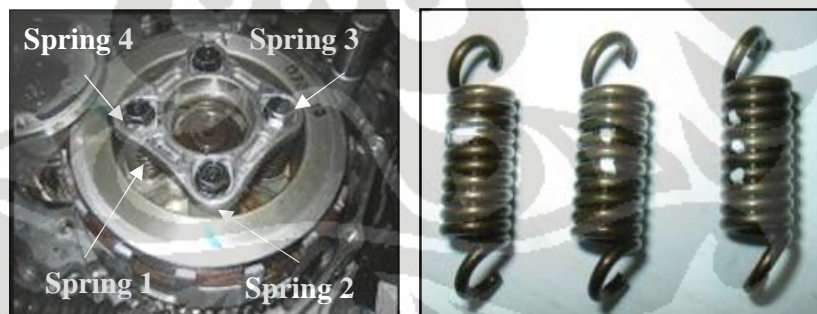
Gambar 3.8. Ilustrasi Komponen Kopling Spring Clutch
