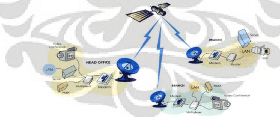
**Gambar 3.3** Konfigurasi jaringan VSAT SCPC
