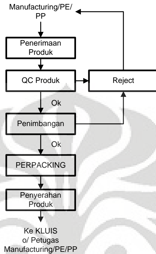
Gambar 3.2 Bagan Alir proses Aliran Produk Jadi di Unit Kerja PPM
