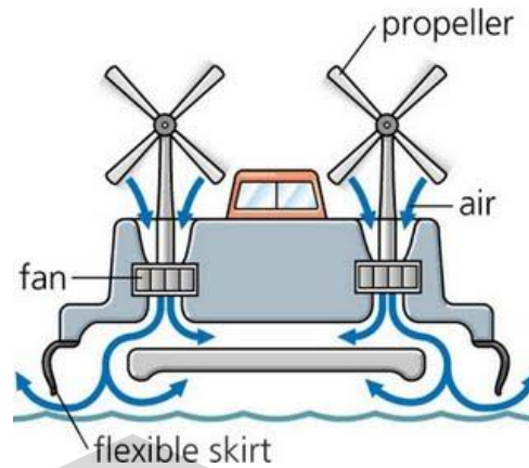
Gambar 2.2. Air cushion dengan fleksible skirt
