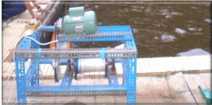
Gambar 3.10 Rangkaian untuk alat tarik kapal model
