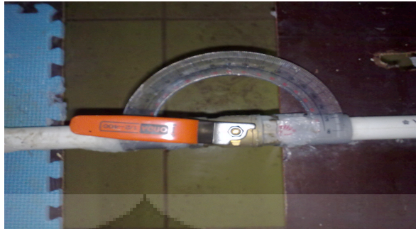
Gambar 3.3 Valve dengan Busur Derajat
