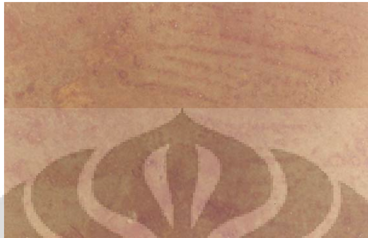
Gambar 4.11 Foto sampel tampak atas dengan pembesaran 10 kali setelah perendaman pada 0,002 mol \text{HCO}_3^- dengan inhibitor 50 ppm
