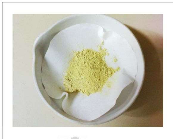
Gambar 4.1 Hasil Sintesis 2-(4-Hidroksibenzilidena)-6-benzilidenasikloheksanon dalam Suasana Asam
