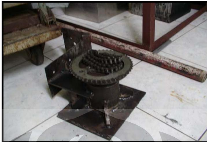
Gambar 3.8 Bearing bambu dirangkai dengan gear dan rantai
