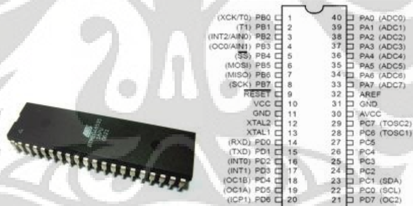
Gambar 2.4: IC ATMEGA 8535 dan pin-pinnya.
