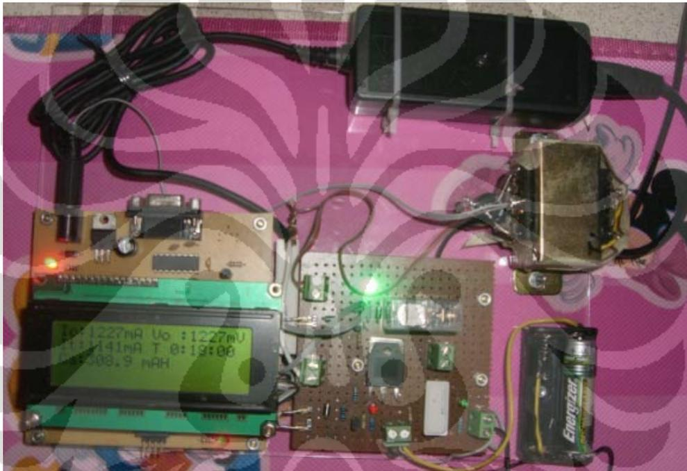
Gambar 3.5. Konstruksi Elektronika Alat Pengukur Kapasitas Baterai
