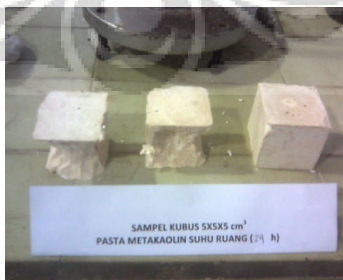
Gambar 4. 6 Hasil uji kuat tekan pasta metakaolin
