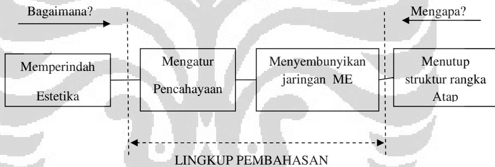
**Gambar 4.2.** Diagram FAST Pekerjaan plafond
