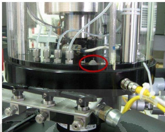
Figure 3.1417. Problème de vidange de l'huile de confinement : orifice de drainage de l'huile avec filtre.
