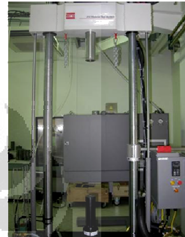
Espace de test vertical avec vérin hydraulique au-dessus
