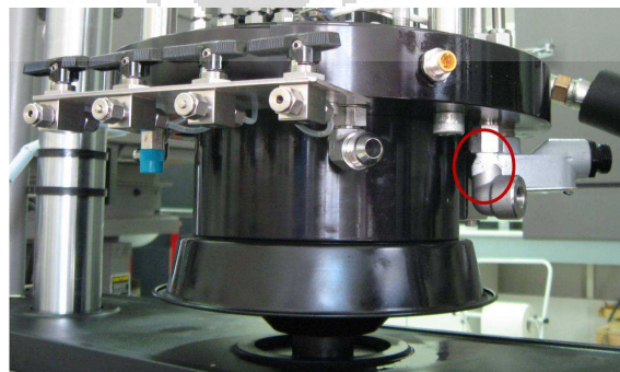
Figure 3.13. Solution pour le problème de l'étanchéité.
