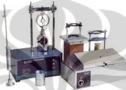
Gambar 2.2. Alat Uji Marshall
