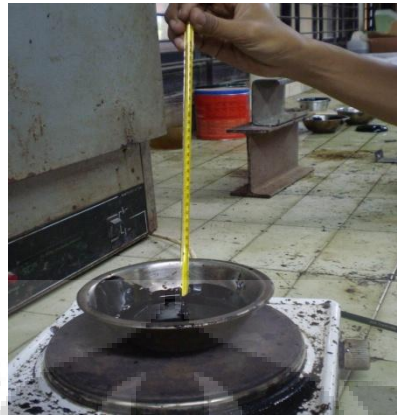
Gambar 4.8. Pemanasan dan Pengukuran Temperatur Aspal
