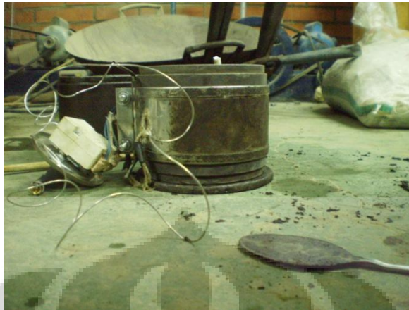
Gambar 4.10. Cetakan Benda Uji Dipasangi Band Heater
