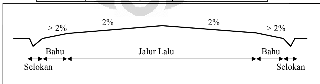
Gambar 2.5 Kemiringan Melintang Jalan Normal
