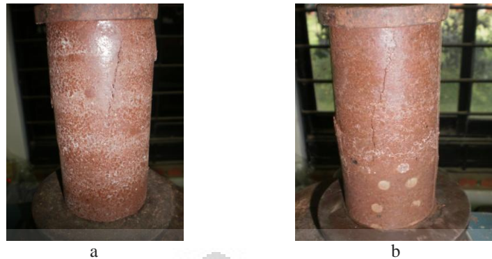
Gambar 4.39 Pengujian Kuat Tekan Bebas Tanah Asli + 10% Semen dengan Pemeraman 6 jam Kemudian Dipadatkan a. Benda Uji Tak Terendam b. Benda Uji Terendam
