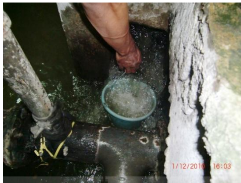
Gambar 4.9 Pengukuran Debit Air Limbah Di Inlet STP 1
