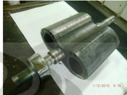
Gambar 4.16 Salah satu lobe blower yang sedang rusak
