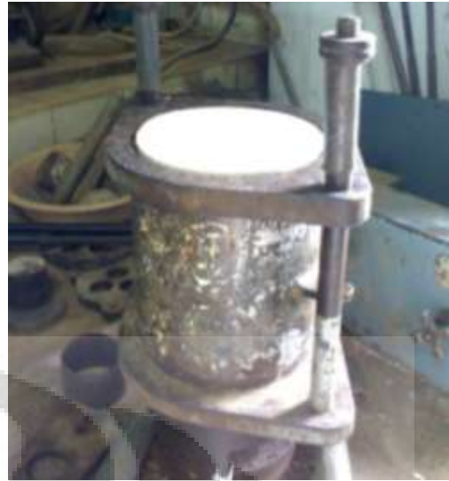
Proses ekstrude dan pencetakan untuk uji Triaksial CU
