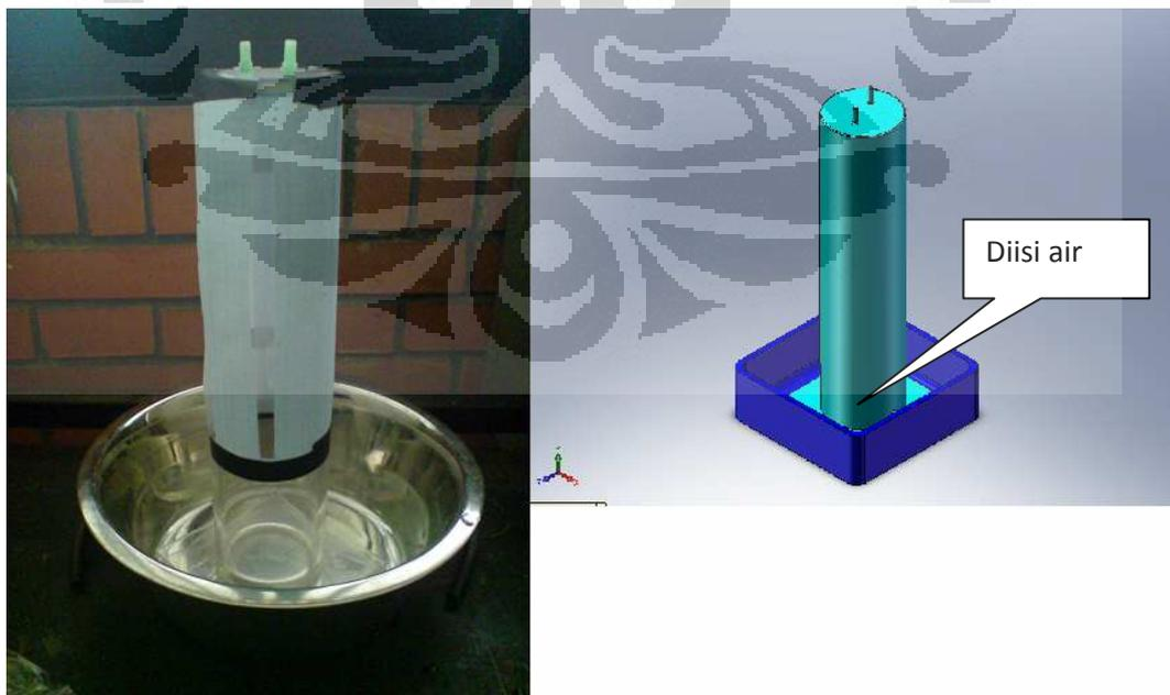
*Gambar 3.3. Tabung ukur gas keluaran elektrolisa air*
