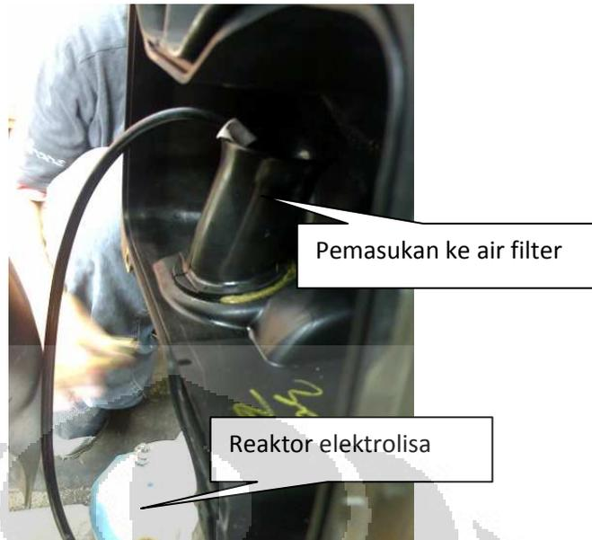
*Gambar 3.8. Posisi injeksi gas elektrolisa air pada air filter.*
