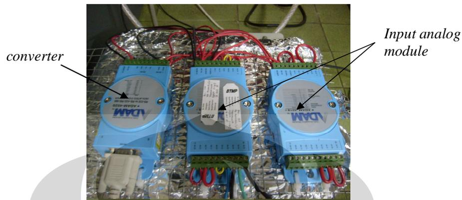
Gambar 3.11 *Input analog module* dan *converter*
