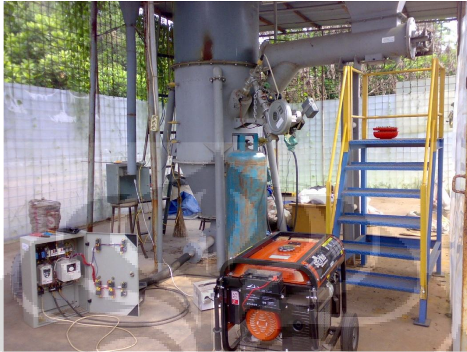
Gambar 3.15 Rangkaian Seluruh Alat untuk Melakukan Pengujian Pembakaran
