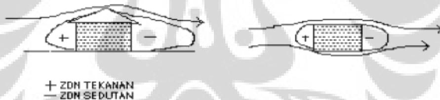
**Gambar 2.1 Aliran udara karena faktor angin**
