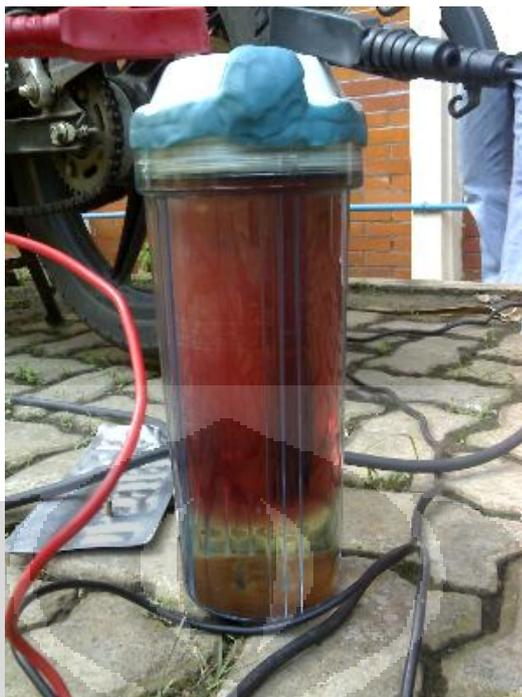
Gambar 3.2. Tabung reaktor elektrolisa.
