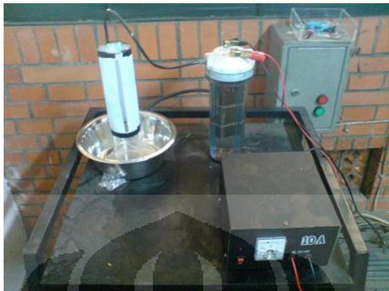
Gambar 3.9. Setup alat untuk pengukuran laju produksi gas elektrolisa air
