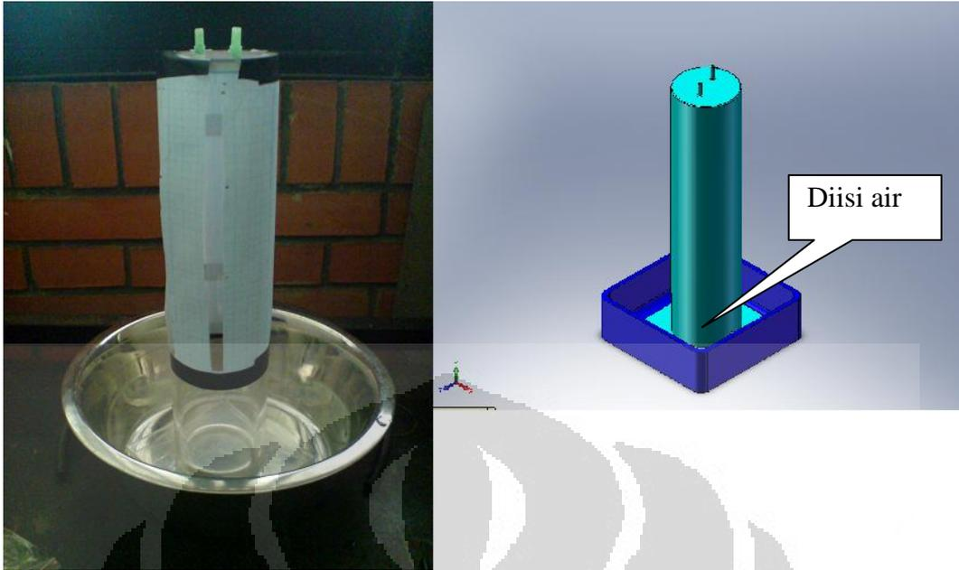
Gambar 3.3 Tabung ukur gas hasil elektrolisa air
